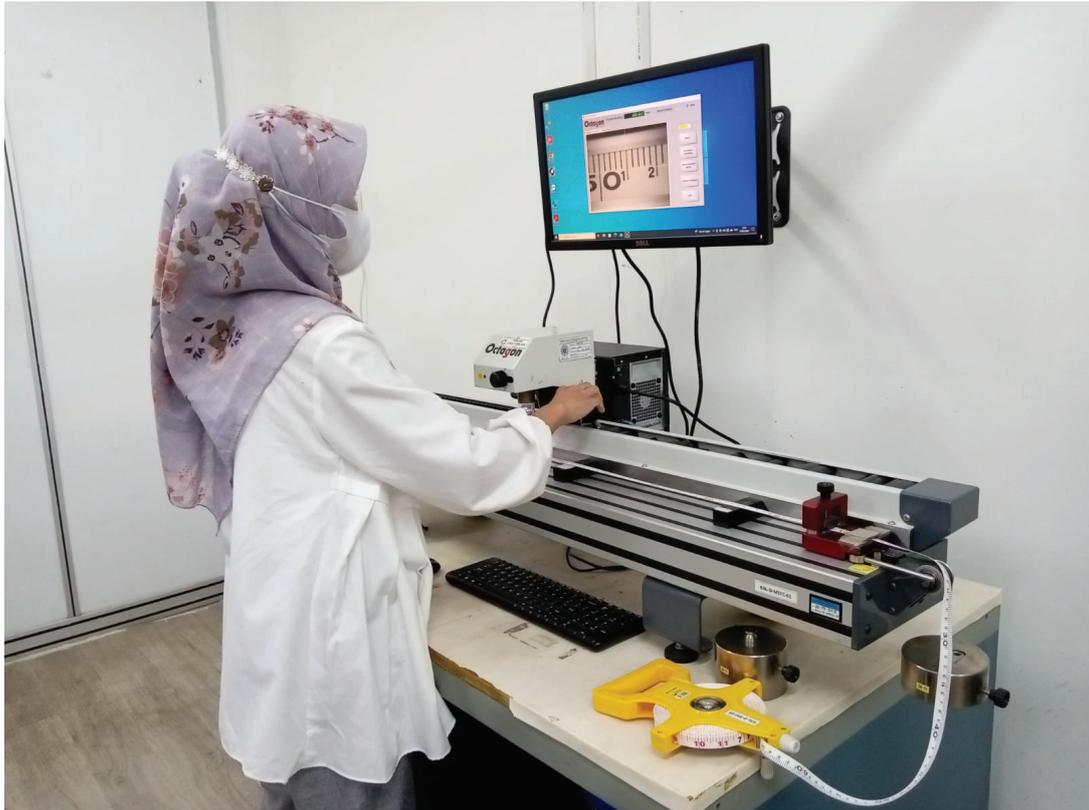
Gambar 6. Kalibrasi rollmeter menggunakan ruler calibrator
