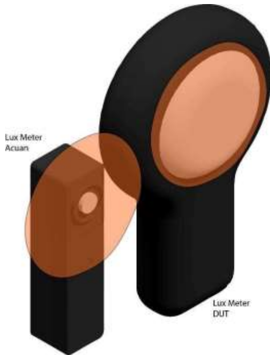
Gambar 5. Baffle ditempatkan sehingga berkas cahaya dari lampu sumber overfilled sensor luxmeter acuan maupun sensor luxmeter DUT (area dengan warna jingga), ini merupakan penempatan posisibaffle yang paling tepat.
