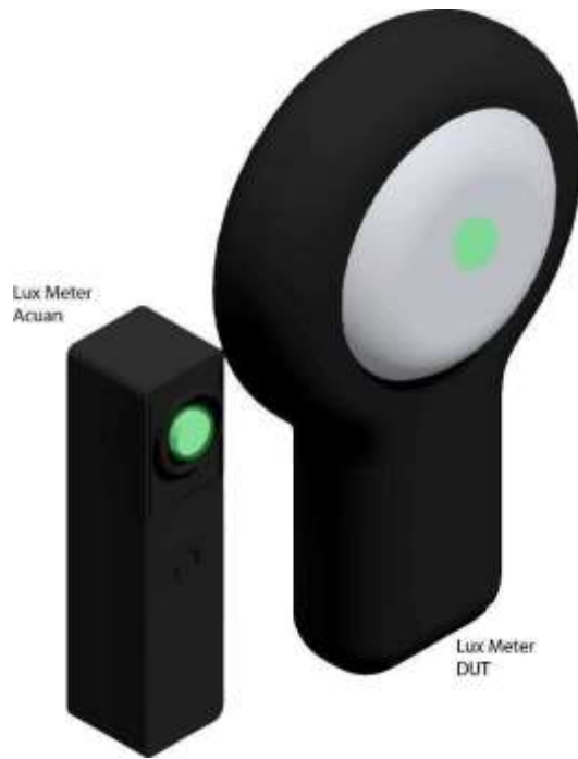
Gambar 4. Baffle ditempatkan sehingga berkas cahaya dari lampu sumber overfilled sensor luxmeter acuan (area dengan warna hijau), akan tetapi karena luasan sensor luxmeter acuan lebih kecil sehingga berkas cahaya menjadi under-filled pada luxmeter DUT.
