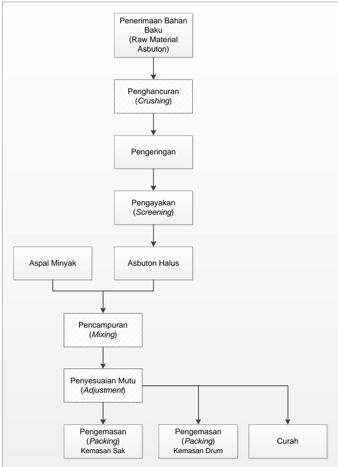
Tahapan proses produksi aspal buton pracampur (bahan baku berupa aspal buton kadar bitumen tinggi/konsentrat)
