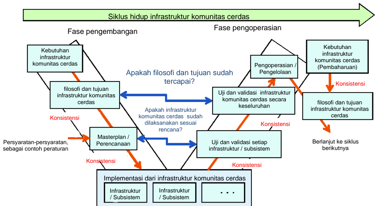
Gambar 12 – Contoh proses yang diterapkan pada pengembangan dan pengoperasian infrastruktur komunitas cerdas
