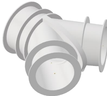
Gambar 9 - Contoh percabangan dua pipa pesat
